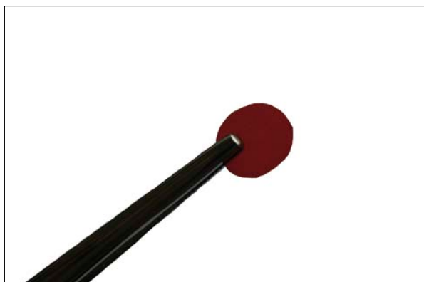
Rycina 2. Zdjęcie matrycy PDLGA (70/30) z doksorubicyną (10% wag.).
